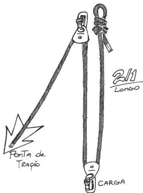
Figura 74 - Sistema 2/1 Longo, Tração Par
