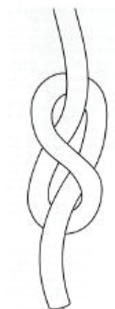
Figura 6 — Nó de figura oito (ou oito simples)
