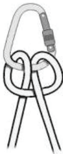
Figura D.10 — Volta do fiel
