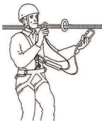
Figura C.12 — Exemplo de instalação de linhas para movimentação horizontal e planos inclinados
