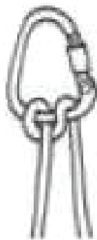
Figura D.11 — Meia volta do fiel (União Internacional das Associações de Alpinismo - Union Internationale des Association d'Alpinisme - UIAA; nó dinâmico)
