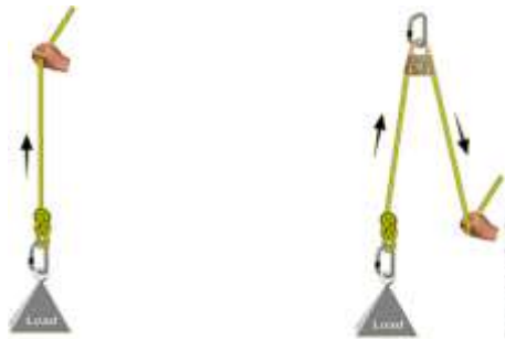
Sistema 1:1 e 1:1 com desvio de direção
