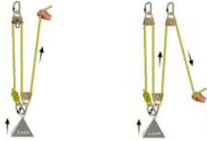
Sistema 3:1 ou “Z” e 3:1 com desvio de direção
