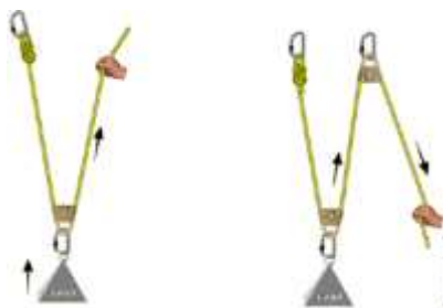
Sistema 2:1 e 2:1 com desvio de direção
