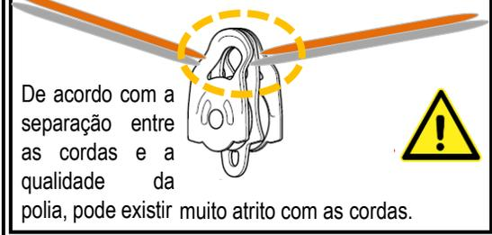
Alguns requisitos de segurança devem ser observados nesse tipo de sistema: tensionamento, pontos de ancoragem, redução mecânica, material utilizado, ângulos formados, número de cordas, resistência dos materiais, etc.
