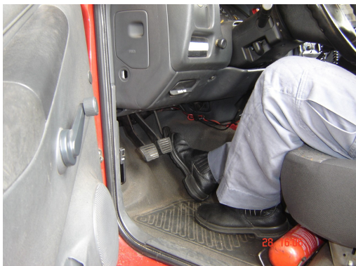
Figura 1. Ajuste do alcance dos pedais.
