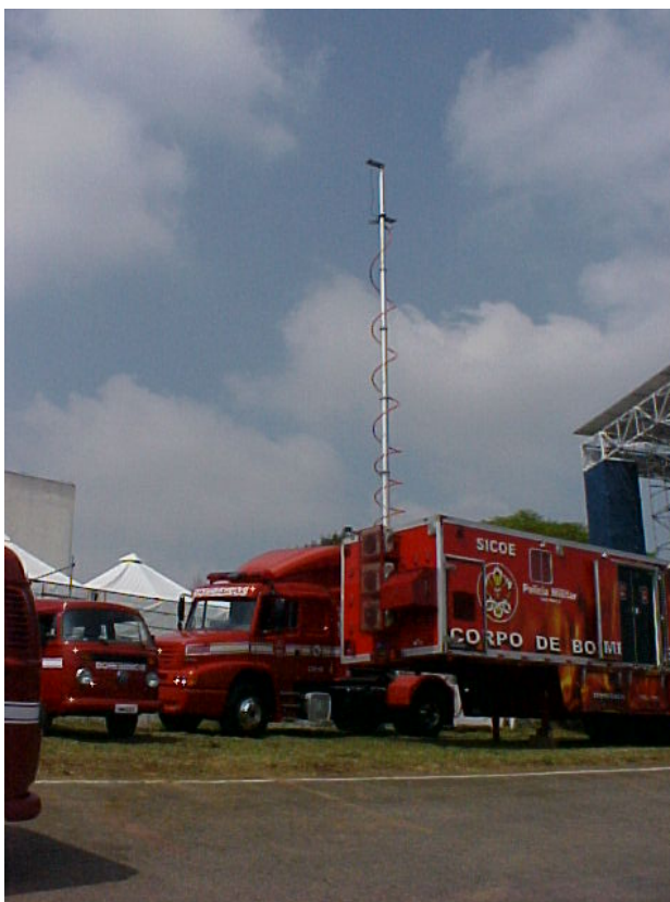
Figura 14. Torre telescópica de uma rádio base móvel
