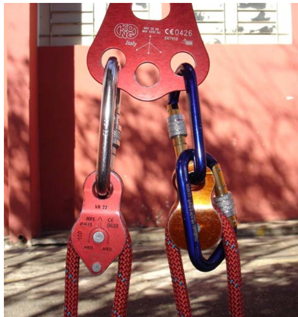
Backup confeccionado na polia sem flange ou pino de segurança
